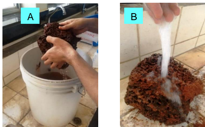
A: Imersão de amostra em água; B: Lavagem de amostra em água corrente. Fonte: Autores.
