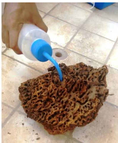
Figura 7 – Adição de água em orifício do cupinzeiro com auxílio de uma pisseta.
